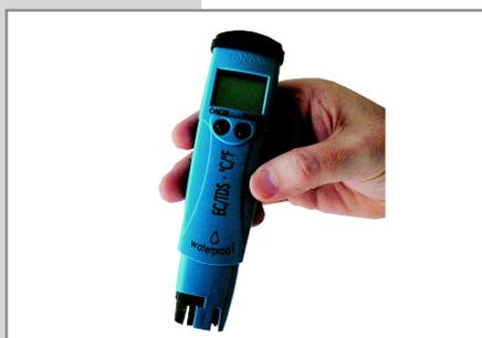
Strumento digitale per la misura immediata e precisa della conducibilità delle soluzioni acquose
