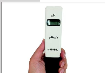
Strumento digitale per la misura immediata e precisa del pH delle soluzioni acquose
