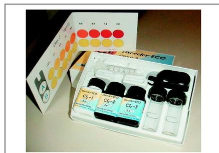
Kit colorimetrico per la determinazione con precisione della concentrazione del cloro in soluzione
