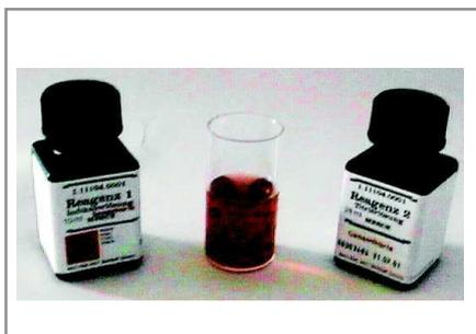
Kit colorimetrico per la determinazione con precisione della durezza delle soluzioni acquose
