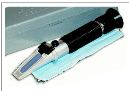
Oculare a rifrazione per la determinazione della percentuale oleometrica nelle emulsioni lubrificanti
